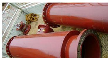
2、上面是 2011 年我们湖南一公为长沙同行设计制造的，用于北方企业的采暖系统加热的“汽水混合器”，流量是 1200 吨/时、600 吨/时各一台。
